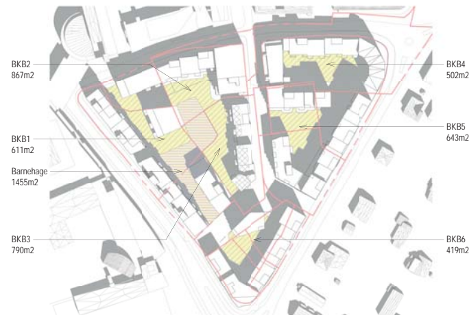
01.05. kl 12 BKB1 med 4 bygg og barnehage i syd
