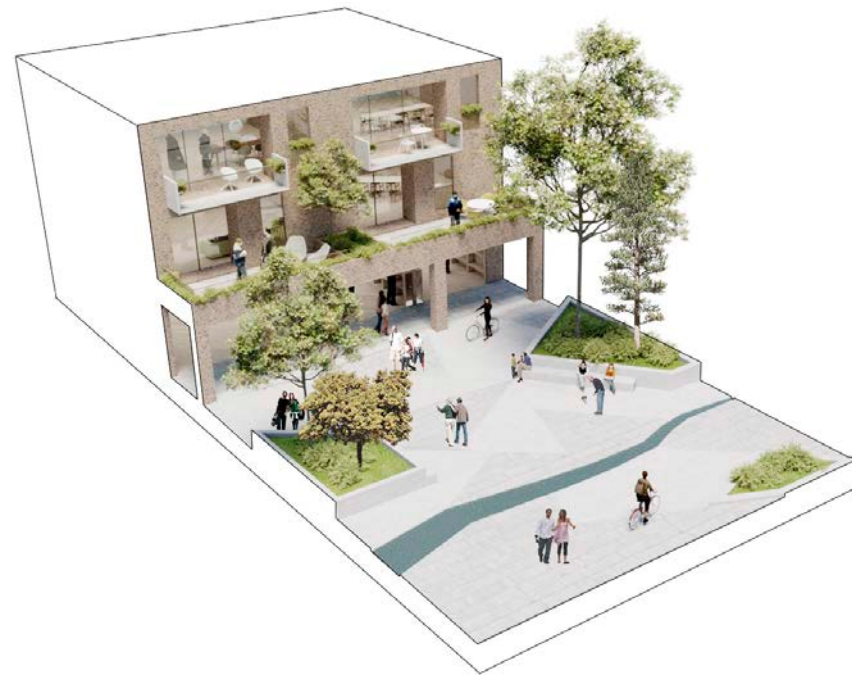
1. Gaten med næring i 1. etasje og boliger oppover i etasjene. Bygulvet har brostein og støpte plantekasser med sittebenker. Overvannet renner gjennom gaten og vannet plantene og trærne på sin vei.
