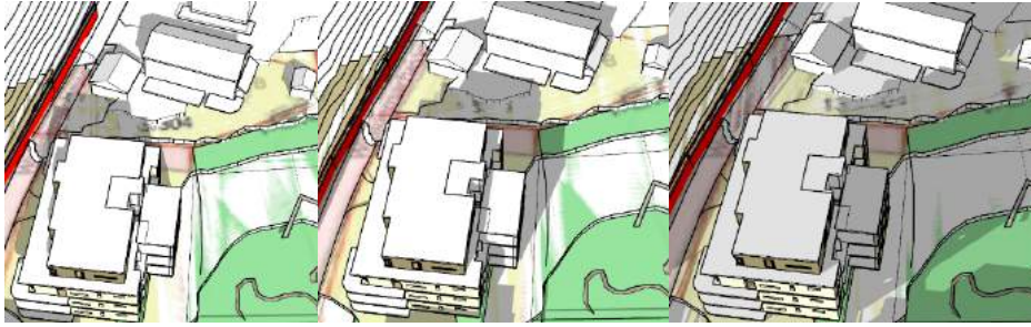
Figur 7-3 Lysforhold for naboeiendom mot Nord vårjevndøgn, 12:00, 14:00 og 16:00
