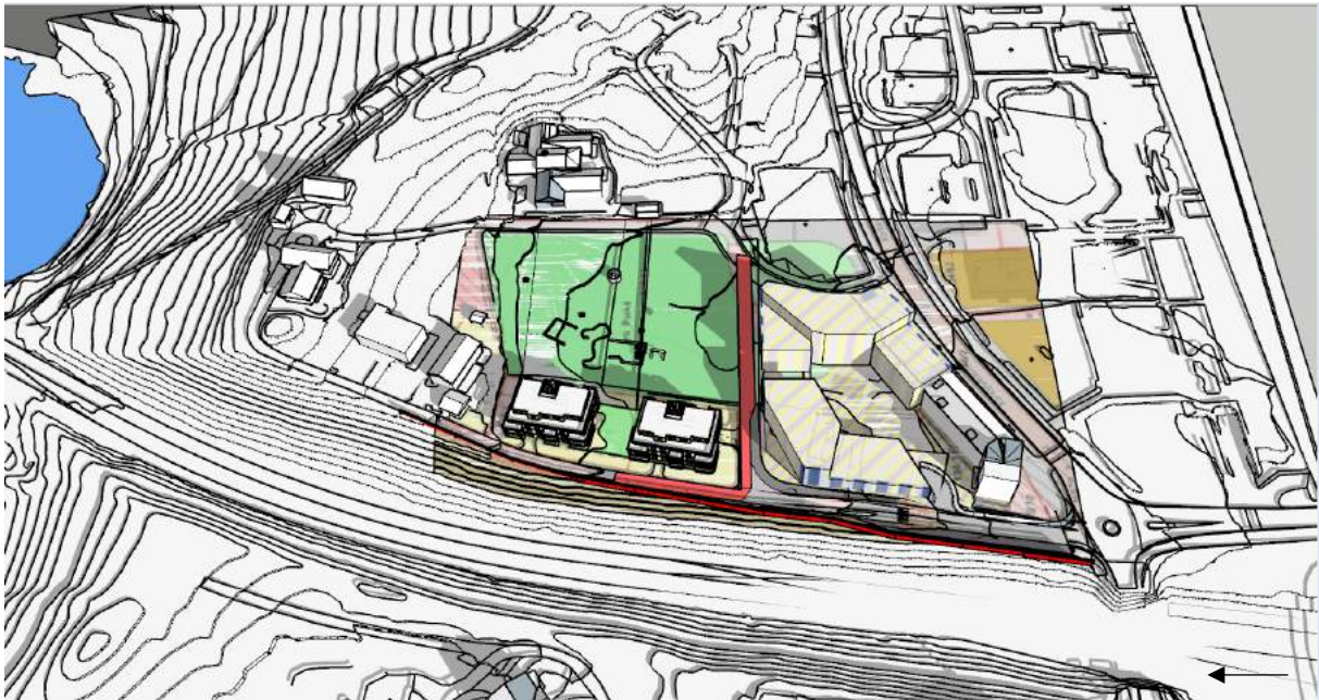
Figur 7-7 Plassering byggene på tomten. Lysforhold kl 15:00 21.mars
