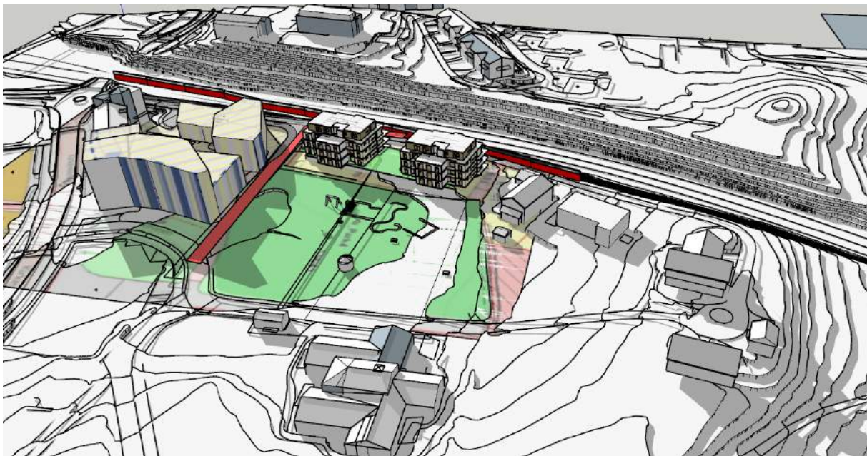
Figur 7-8 Plassering av bygninger og lysforhold kl 15:00 21.mars
