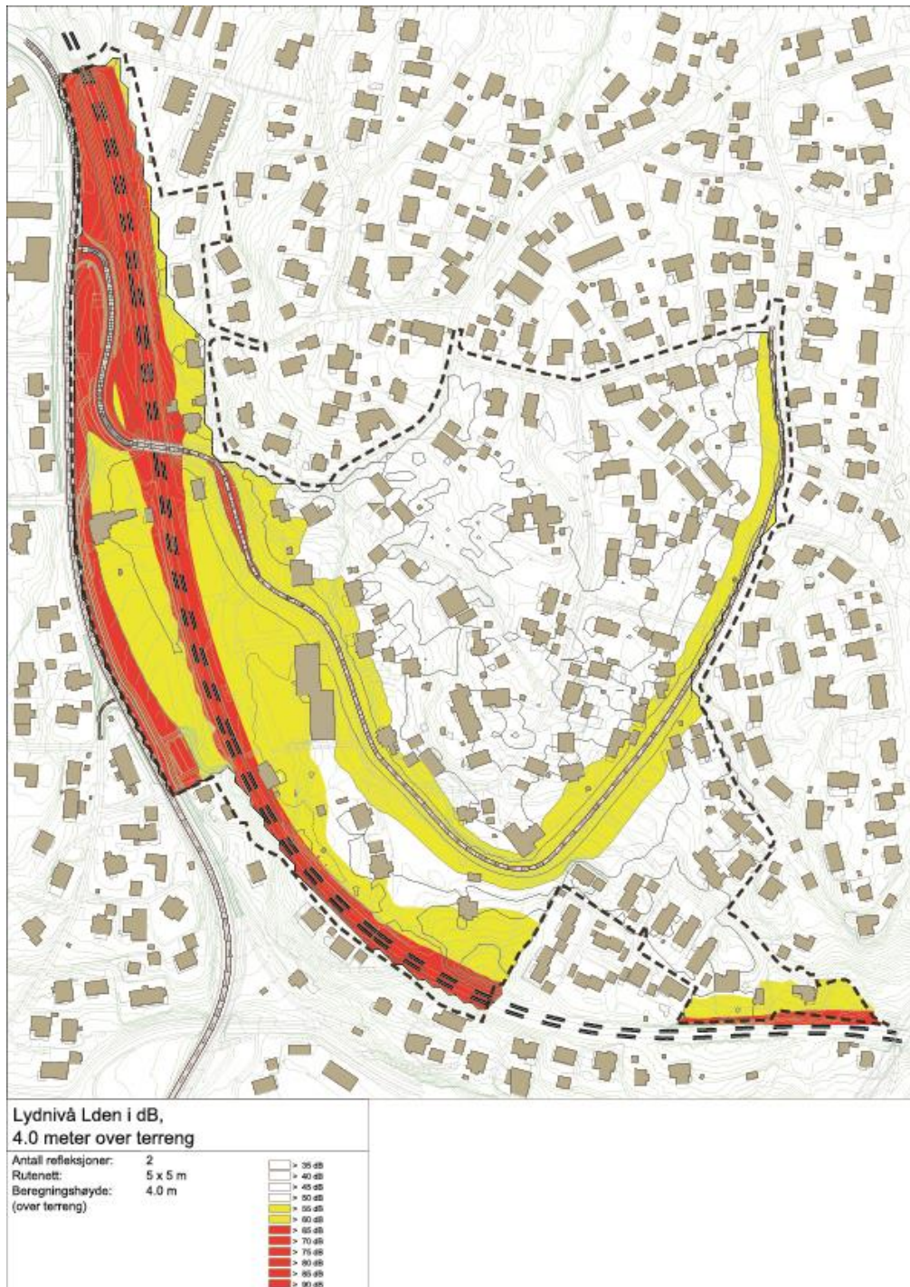
Figur 30. Dagens støysituasjon fra jernbane, Skiveien (fv. 152) og Sætreskogveien. Støyanalysen er utført av Multiconsult.
