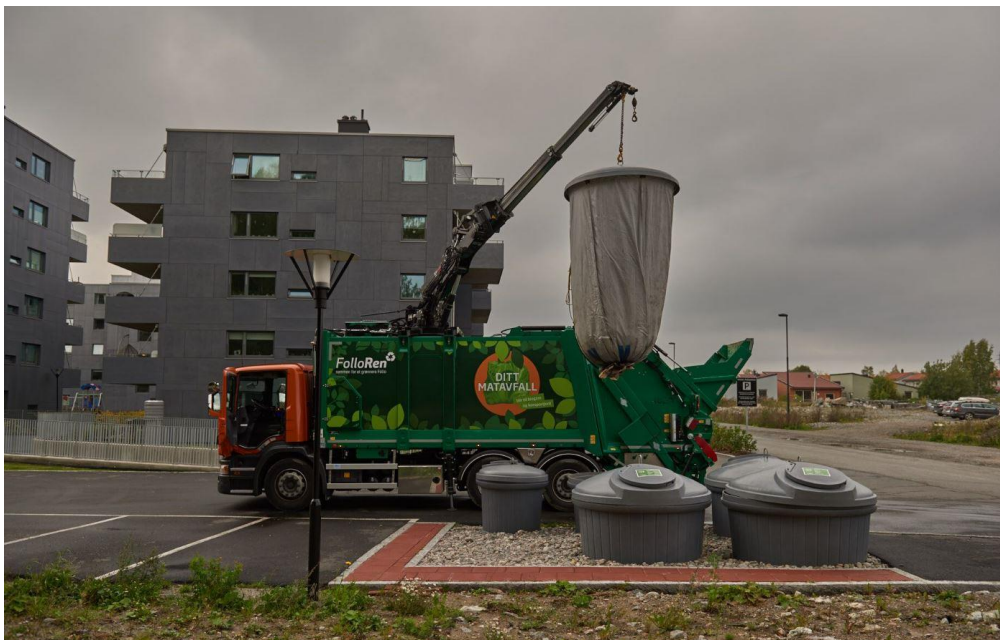
Tømming av delvis nedgravd avfallsbrønn
