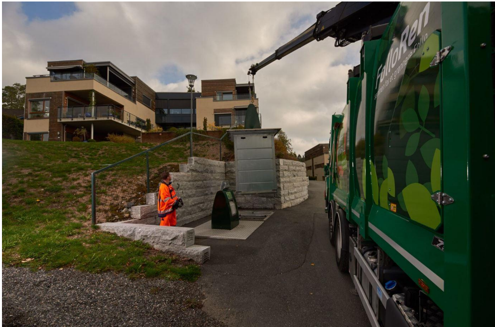
Tømming av helt nedgravd avfallsbrønn
