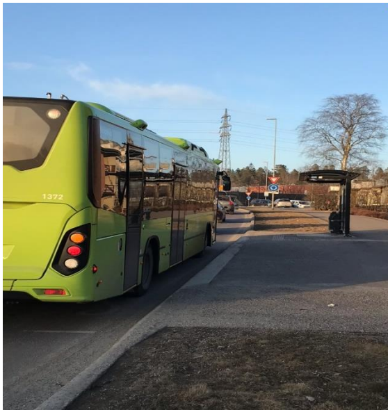
Figur 48. Kantstopp i Åsveien i Ski (Foto: Nordre Follo kommune) Et kantstopp er en holdeplass hvor bussen stopper i vegbanen. Når andre kjøretøy må vente bak bussen, reduseres bussens ventetid ved inn- og utkjøring til holdeplassen. Det gir bedre fremkommelighet og mer forutsigbare rutetider for bussen.
