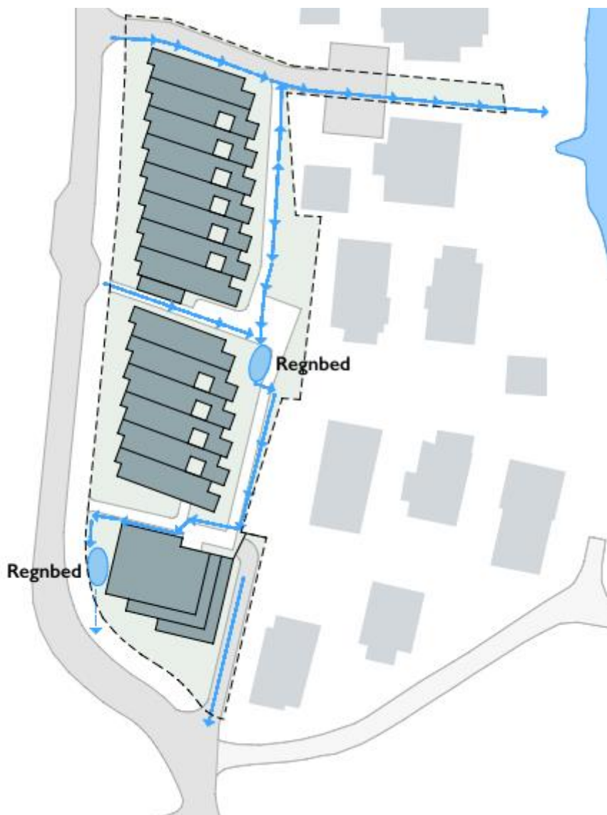
Figur 10: Skisse som illustrere flomveier ut av feltet ved styrtregn, se vedlegg 3.
