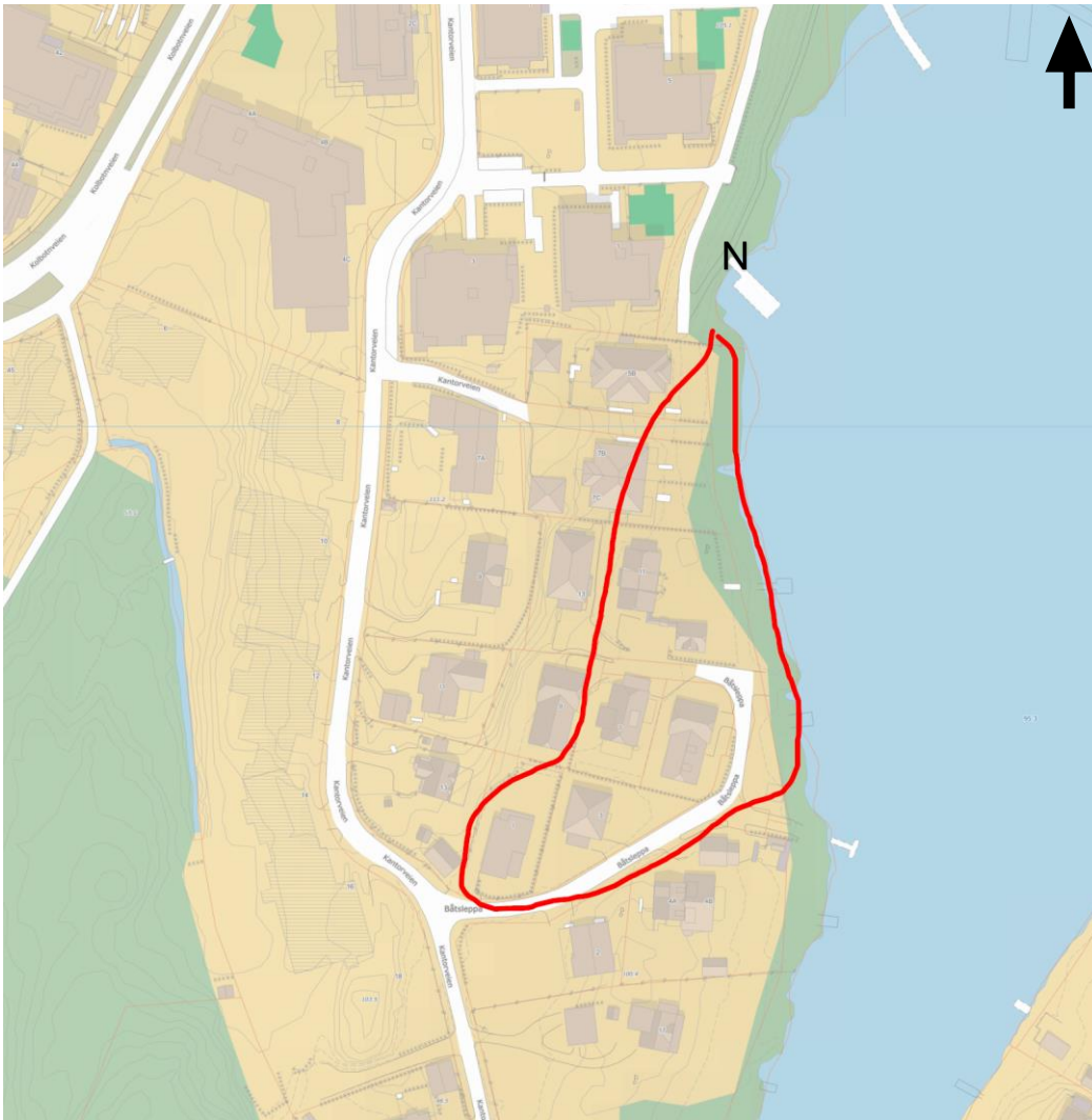
Figur 4 Områder med boliger fundamentert på peler
